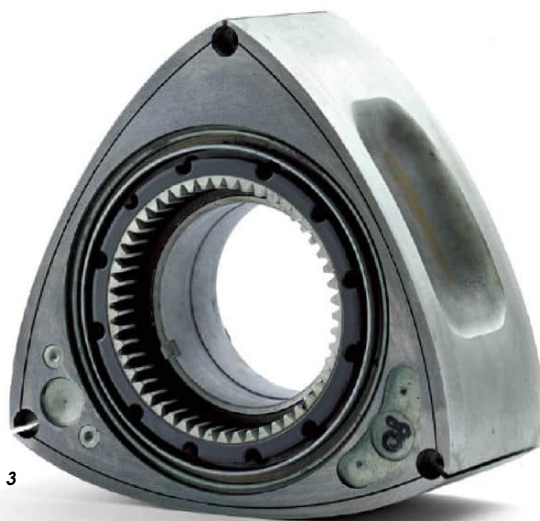
1 エンジンベンチにかけられるベリフェラルポートの20B型3ローターNAエンジン。20Bに13Bのパーツを組み込むなどして最適化したハイブリッド仕様だ。2 吸気ポートが設けられたベリフェラルポート仕様のローターハウジング。3 ローターはNAで9.7と圧縮比の高い輸出用FC3Sのものを採用。それよりもRX-8用のほうが圧縮自体は高かったが、GTで使用するには不向きだとされる。4 2分割式のアベックスシール。GTでは耐久性を求め、摩擦に強いセラミック製を使うようになった。5 ドライサンプのオイルポンプと6 レギュレーションにより装着されるリストラクター。7 ミッションはヒューランド製の6速シーケンシャルだった。
