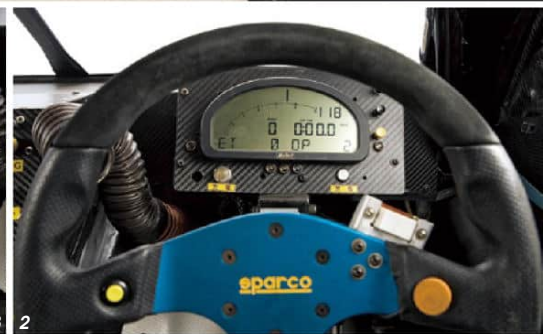
112 スパルコのステアリングとモーテックのメーターが備わるコックピット。ステアリングの左にはパッシング、右にはラジオスイッチ、さらに右奥には白いウインカースイッチが装備されていた。12 センターのパネルにはエンジンスタートやワイパー、ピットロードリミッターなどのスイッチ類が並ぶ。ドライバー側に傾いているシフトレバーも特徴的だ。
