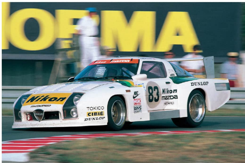
縦置きヘッドライト付きの新ノーズ、2重ルーフのリヤ処理とウイングの復活、ワイドボディ化などで究極のRX-7となった254。しかし写真のウォーキンショー/ロベット/ニコルソンの83号車はエンジントラブルに泣く。
