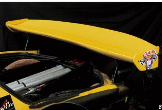
1 エンジンフード、2 リヤハッチ、3 フロントバンパー、4 リヤバンパー、5 フロントスポイラー&アンダーパネル、6 サイドステップ、7 フロントフェンダー、8 リヤウイング、9 リヤフェンダーというエクステリアを構成するエアロパーツたち。1 エンジンフードはセパンなど熱に厳しいレースのときにはエンジンルーム内の排熱のためにダクトにフィンが追加されることもあった(写真は非装着)。このフィンの装着でフロントのダウンフォース量も変化した。10 マシンの下面はネックだった排気温度のためにミッション付近は覆われていないものの、ほぼ全面的にフラットボトム化されている。11 2005年にはマツダの三次試験場にて風洞実験を実施。しかし量産車用の風洞だったため、レース向けの開発に役立てることはあまりできなかった。
