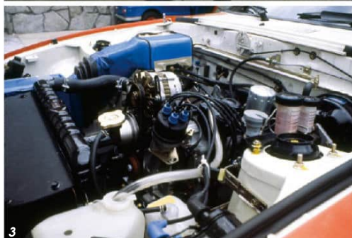
1 79年デイトナ24時間の事前テスト、ピットで出走を待つ77号車。2 コックピット内のバケットシートなどは、マツダのスポーツキットとして市販されたもの。3 デイトナの砂対策がほどこされたエンジンルーム。
