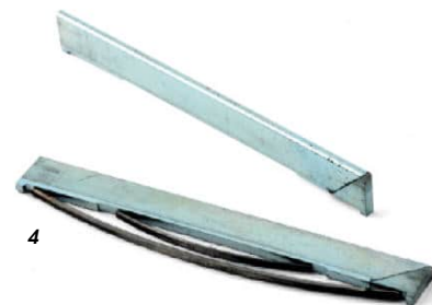
1 エンジンベンチにかけられるベリフェラルポートの20B型3ローターNAエンジン。20Bに13Bのパーツを組み込むなどして最適化したハイブリッド仕様だ。2 吸気ポートが設けられたベリフェラルポート仕様のローターハウジング。3 ローターはNAで9.7と圧縮比の高い輸出用FC3Sのものを採用。それよりもRX-8用のほうが圧縮自体は高かったが、GTで使用するには不向きだとされる。4 2分割式のアベックスシール。GTでは耐久性を求め、摩擦に強いセラミック製を使うようになった。5 ドライサンプのオイルポンプと6 レギュレーションにより装着されるリストラクター。7 ミッションはヒューランド製の6速シーケンシャルだった。
