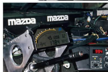
(上) IMSA仕様はアナログ式メーターパネルが採用されていたが、(下)ル・マン仕様はPIシステムのデジタルディスプレイに変更されていた。
