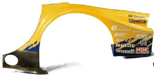
1 エンジンフード、2 リヤハッチ、3 フロントバンパー、4 リヤバンパー、5 フロントスポイラー&アンダーパネル、6 サイドステップ、7 フロントフェンダー、8 リヤウイング、9 リヤフェンダーというエクステリアを構成するエアロパーツたち。1 エンジンフードはセパンなど熱に厳しいレースのときにはエンジンルーム内の排熱のためにダクトにフィンが追加されることもあった(写真は非装着)。このフィンの装着でフロントのダウンフォース量も変化した。10 マシンの下面はネックだった排気温度のためにミッション付近は覆われていないものの、ほぼ全面的にフラットボトム化されている。11 2005年にはマツダの三次試験場にて風洞実験を実施。しかし量産車用の風洞だったため、レース向けの開発に役立てることはあまりできなかった。
