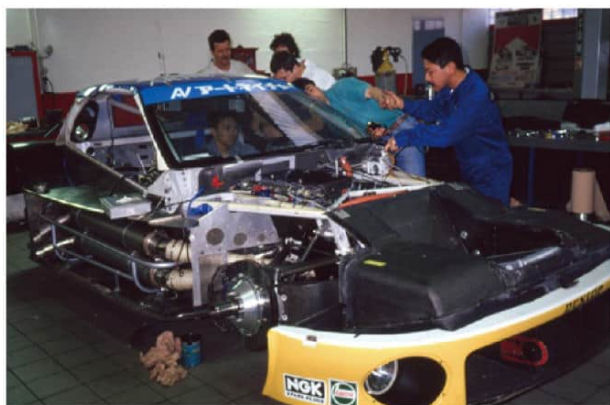
エキゾーストパイプは放熱性と排気抵抗に優れた2段重ねタイプが採用され、さらに断熱バンテージが巻かれている。また、集合部にはインコネル材が使われている。
