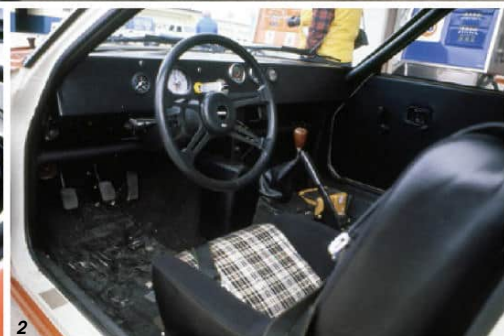
1 79年デイトナ24時間の事前テスト、ピットで出走を待つ77号車。2 コックピット内のバケットシートなどは、マツダのスポーツキットとして市販されたもの。3 デイトナの砂対策がほどこされたエンジンルーム。
