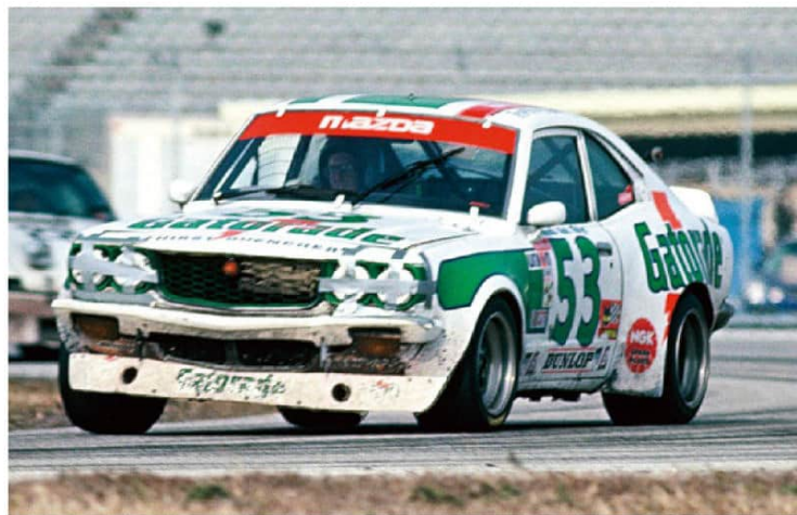
ヘッドライトカバーがダクトテープで固定されているのは、デイトナの飛砂によるヘッドライト破損防止のため。またチンスボイラーのGatoradeロゴはその飛砂で削り取られた。それもデイトナに参戦して初めて分かったこと。
