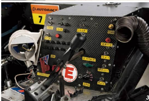
112 スパルコのステアリングとモーテックのメーターが備わるコックピット。ステアリングの左にはパッシング、右にはラジオスイッチ、さらに右奥には白いウインカースイッチが装備されていた。12 センターのパネルにはエンジンスタートやワイパー、ピットロードリミッターなどのスイッチ類が並ぶ。ドライバー側に傾いているシフトレバーも特徴的だ。
